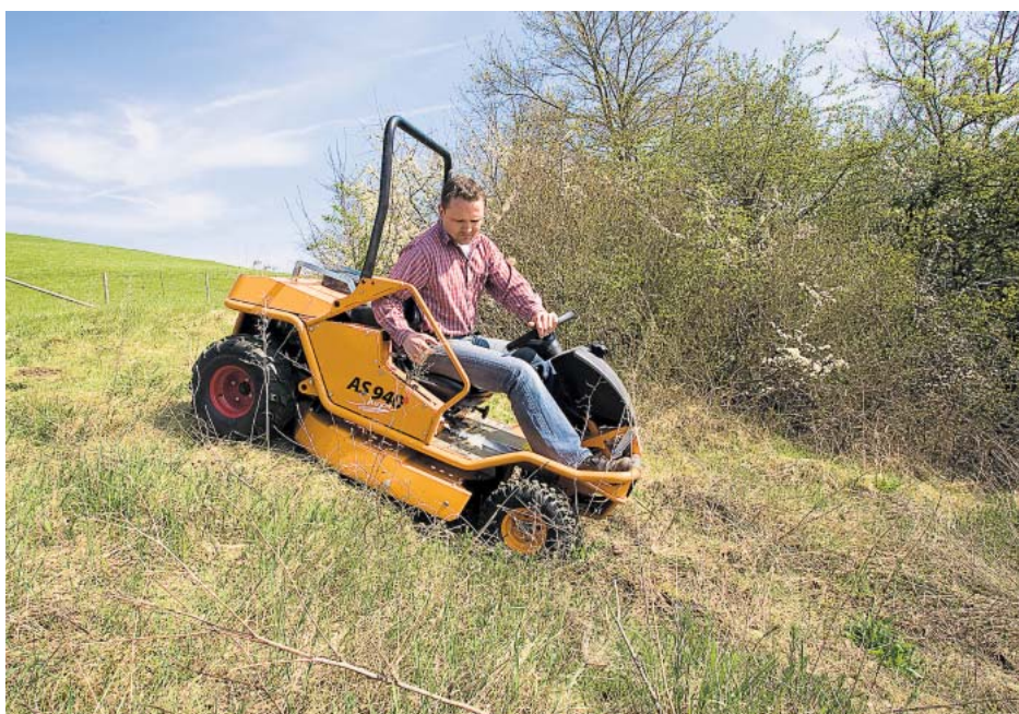
dienen als „Bodenverbesserer“. Das schafft auch der Aufsitzmäher AS 940 Sherpa, dem ein Hydrostatgetriebe einen stufenlosen Allradantrieb und damit die Kletterfähigkeit einer Bergziege verleiht.
