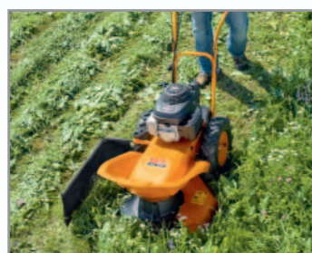
Das Zusammenrechen entfällt: Ablage des Schnittgutes in einem Schwad beim Mähvorgang.
