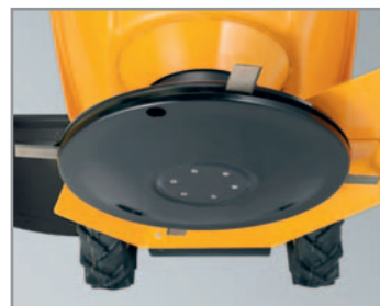
Stabile Kreiselmähscheibe mit ausgeprägtem Versteifungsrand und 4 beweglich gelagerten Messern.
