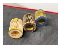
Bild 3: Klopfen Sie den Luftfilter vorsichtig aus, um trockenen Staub, Pflanzensamen und Fremdkörper zu entfernen.
