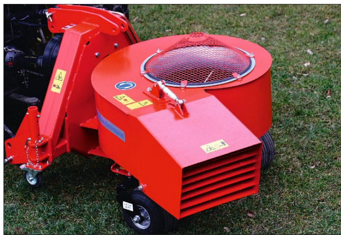
Mega Twister von Wiedenmann: Kraftvoller Laubbläser mit weit schwenkbarer Düse für Kompakttraktoren.
