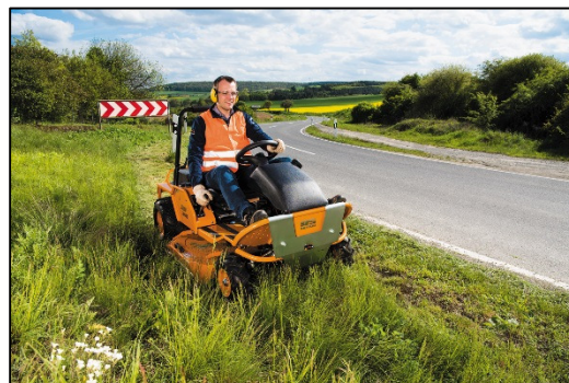
Bild 2: Satte 27 PS unter der Haube, eine Schnittbreite von fast einem Meter und mit bis zu 11,5 Stundenkilometern unterwegs
