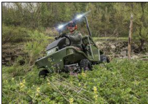
Bild 3: Die Sonderedition verfügt über zwei zusätzliche 18 Watt LED-Scheinwerfer und eine Transportbox
