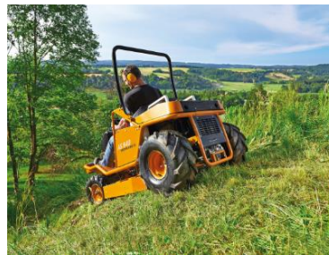
Bild 4: Am Hang besticht der AS 940 Sherpa 4WD XL mit seinem permanenten Allradantrieb, seiner großen XL-Ackerstollenbereifung und einem sehr niedrigen Schwerpunkt
