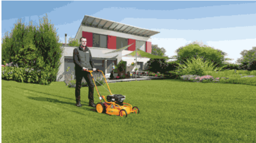
Bild 1: Rein äußerlich erkennt man Mulch-Rasenmäher am fehlenden Fangsack und an der runden, geschlossenen Form der Mähhaube.
