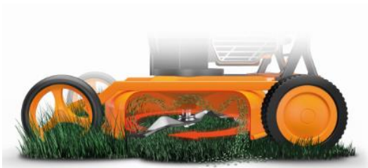
Bild 3: In der Mulchglocke erzeugt das rotierende Messer einen kreisenden Luftstrom, der abgeschnittenes Gras verwirbelt. Dabei wird es von einem Spezial-Mulchmesser fein zerkleinert und auf die Oberfläche des Rasens zurückgegeben.
