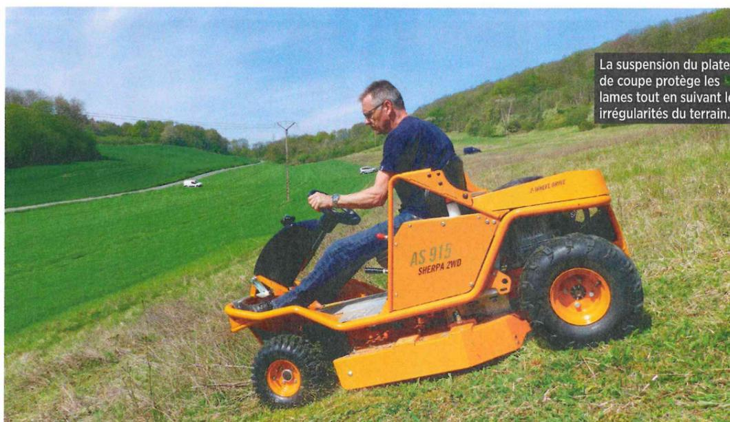
La suspension du plateau de coupe protège les lames tout en suivant les irrégularités du terrain.
