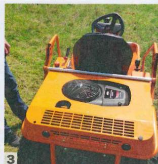
1- Les pots d'échappement sont intégrés à la carrosserie de façon que rien ne dépasse à l'arrière de la machine, qui peut ainsi reculer au maximum de son gabarit.
