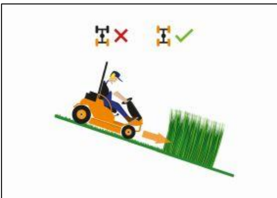
Bild 1: Für die Arbeit an steilen Hängen kommen aus Sicherheitsgründen nur Aufsitzmäher mit Allradantrieb infrage, auch eine Differentialsperre ist kein Luxus
