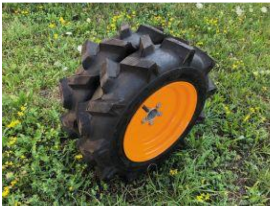
Bild 5: Agrarprofil- und/oder Doppelbereifung verbessern die Traktion
