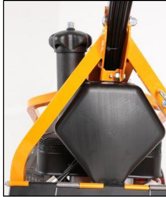
Bild 8: Unten spitz zulaufende Tanks sorgen dafür, dass der Sprit auch im Steilhang zum Motor gelangt
