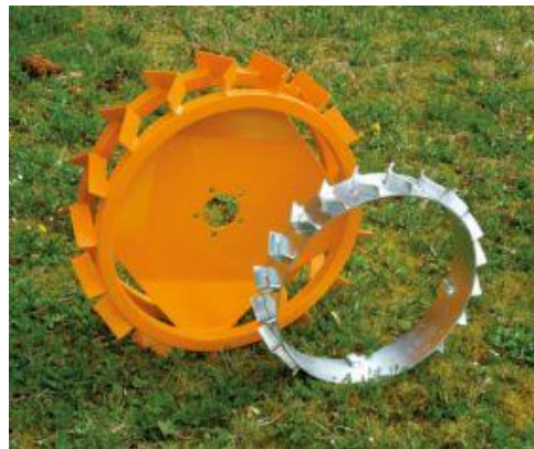
Bild 6: Auch Spikes oder Stahlräder als Steighilfe sind bei Extremhängen ab ca. 40 Grad Neigung unerlässlich
