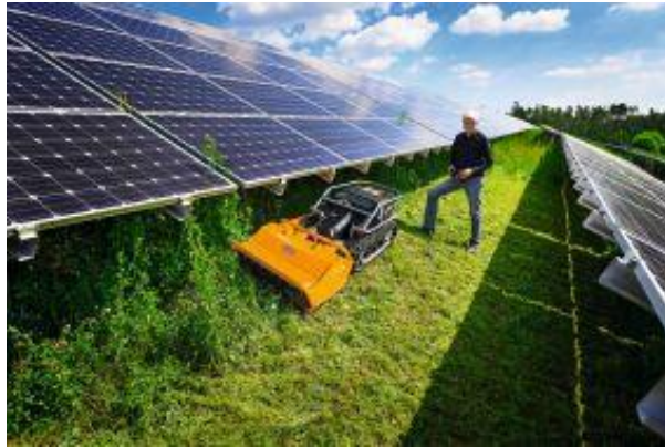
Bild 6: Wichtig ist bei ferngesteuerten Mähern, wie der Mähraupe AS 751 RC, nicht vor oder unterhalb des Geräts zu laufen
