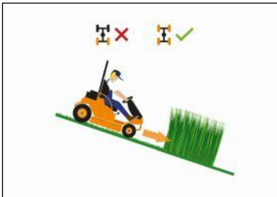
Bild 1: Für die Arbeit an steilen Hängen kommen aus Sicherheitsgründen nur Aufsitzmäher mit Allradantrieb infrage, auch eine Differenzialsperre ist kein Luxus
