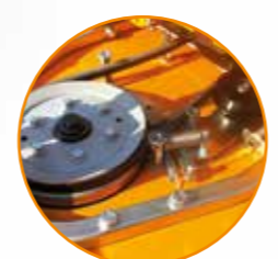
Motorschutz durch getrennte Motor- und Messerwelle, Messeruntersetzung 1:1,6 für hohe Mähkraft
